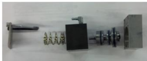
Ensamble de válvulas piloteadas por aire
