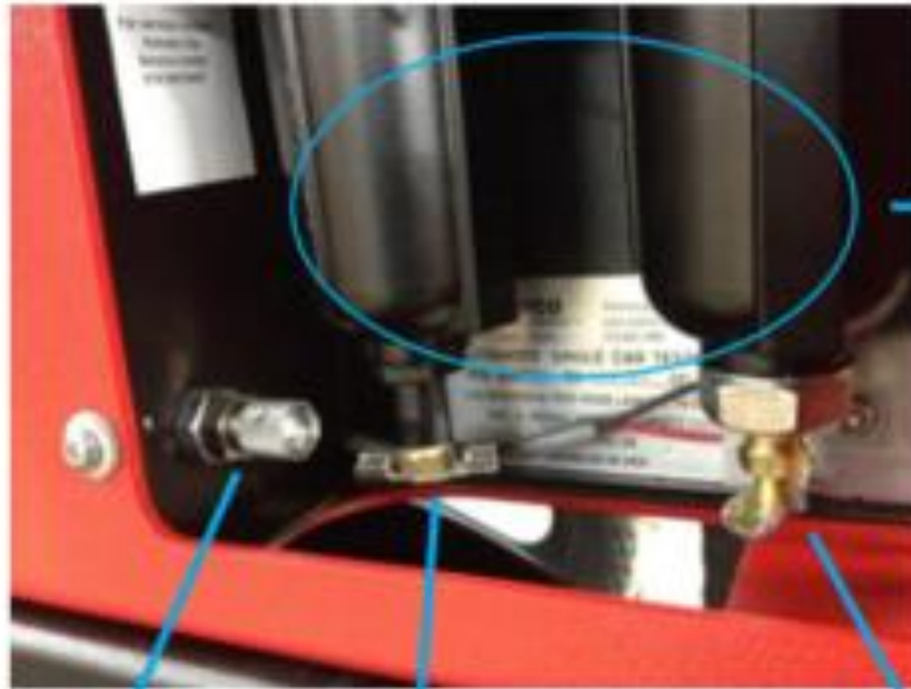
Dren Prueba Diaria para el filtro de partículas
